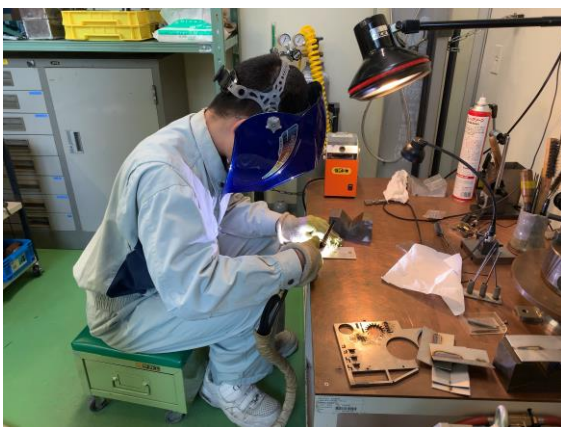
図 1. 共付け溶接の様子
