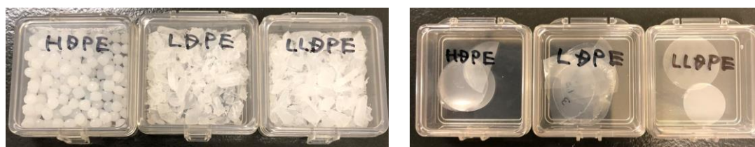
図 2. 使用したポリエチレン（左）加工前（右）加工後
