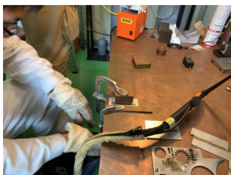
図 5. 作業台への固定
