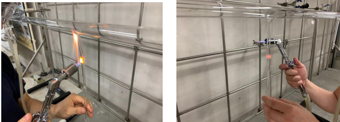
図 21. 真空ラインへの取り付け
