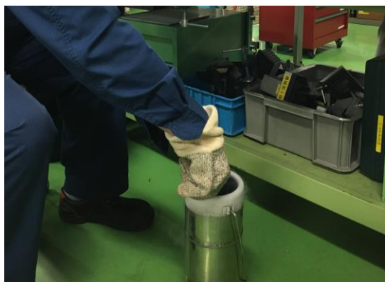
図 24. 液体窒素を用いて冷却
