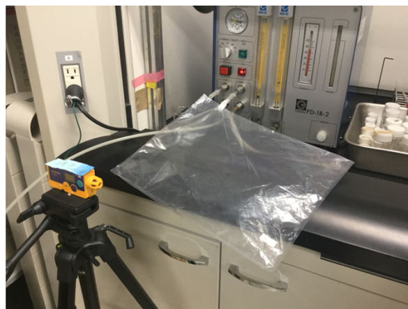
図 3. 標準ガス調整中(左)、標準ガスをサンプルバックに注入(右)
