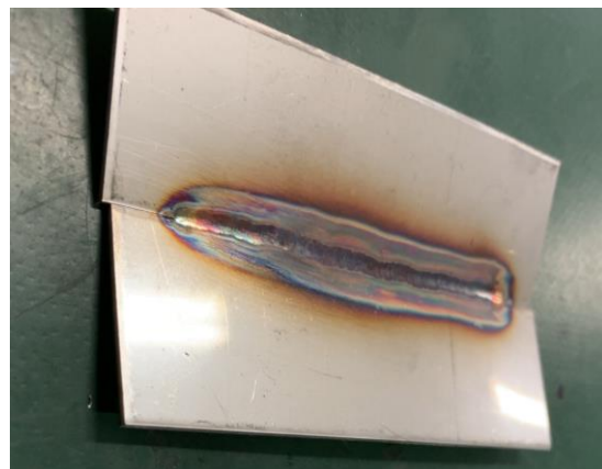
図 2. 突き合わせ溶接した試験片
